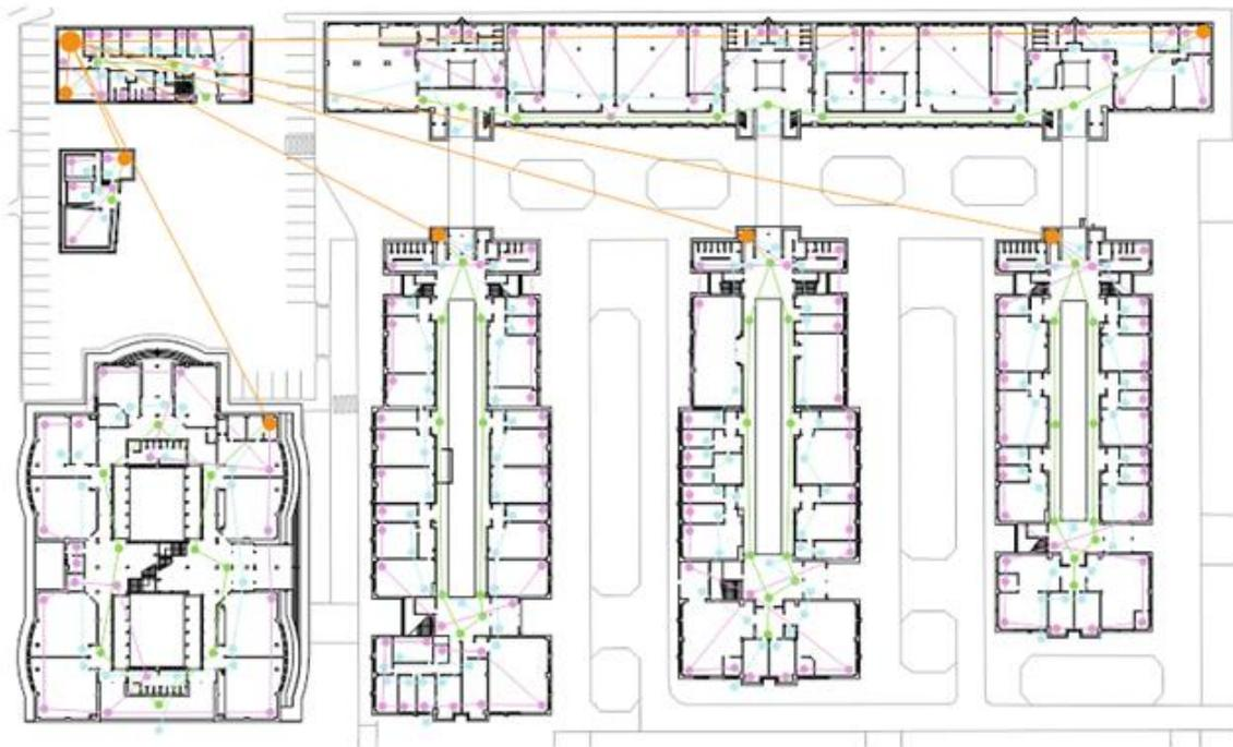
Figura 1. Proyecto de distribución del sistema de información y sensorización en las instalaciones de la Escuela Politécnica.
